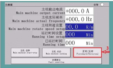
SET UP, CLICK ON THE RELEVANT OPERATING SCREEN START-STOP BUTTON, YOU CAN OPERATE.
